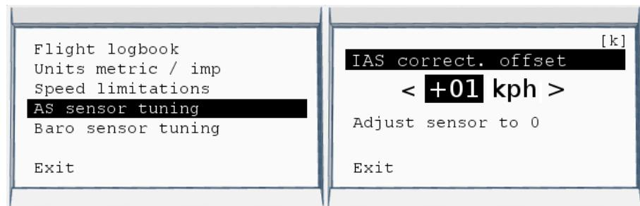
Воздушная скорость летательного аппарата определяется с помощью приемника воздушного давления, который должен быть корректно установлен. Если в измерениях воздушной скорости наблюдаются значительные отклонения в следствии аэродинамического воздействия элементов летательного аппарата на воздушный поток у ПВД, в настройках прибора необходимо указать корректирующее показания значение. Этот значение задается с помощью под пункта меню «IAS correct. Offset» в диапазоне  $\pm 20$  км/ч.
