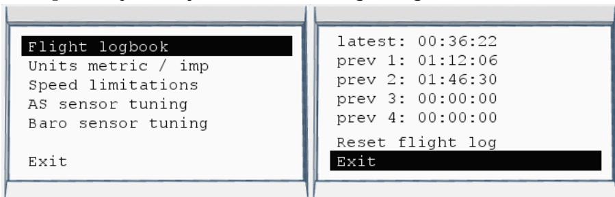
Учет полета производится с момента превышения приборной скорости ВС установленного значения минимальной скорости (Vs) (см. Калибровка датчика воздушной скорости) до момента снижения скорости ниже минимальной (Vs) минус 20 км/ч (10 узлов) и продолжительностью более 60 секунд.
