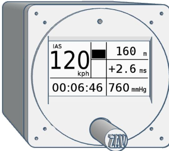
Прибор ZAV PI-1 предназначен для индикации основных параметров полета ВС.
