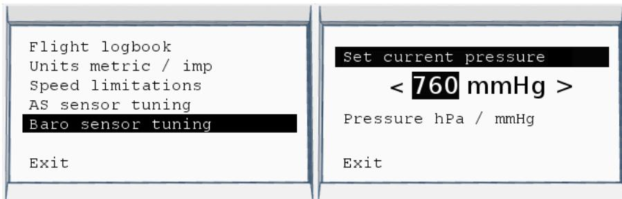
Эта процедура выполняется в пункте меню «Baro sensor tuning». Необходимо свериться с откалиброванным прибором измерения давления и ввести текущее значение базового давления в выбранных единицах измерения.
