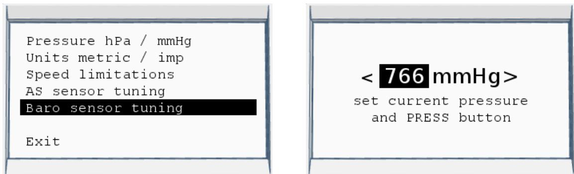
Эта процедура выполняется в пункте меню «Baro sensor tuning». Необходимо свериться с откалиброванным прибором измерения давления и ввести текущее значение базового давления в выбранных единицах измерения.
