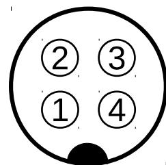
Расположение контактов разъема на задней панели прибора
